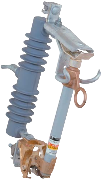
Número de Catálogo 89031R10-P-D▲ Estilo Aéreo Montado en Postes de Carga Ultra Pesada, con capacidad de 14.4 kV nominales, 15 kV máximos, 110 kV NBAI, 100 amperes continuos, 16,000 amperes de interrupción RMS asimétrica, distancia de fuga mínima a tierra de 8 1/2 pulgadas (216 mm).
