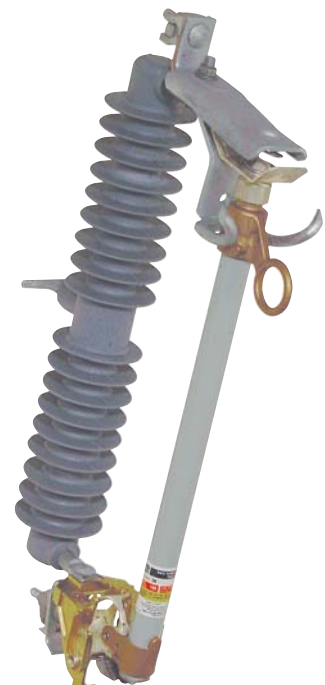
Número de Catálogo 89053R10-P-D▲ Estilo Aéreo Montado en Postes de Carga Ultra Pesada, con capacidad de 25 kV● nominales, 27 kV máximos, 150 kV NBAI, 100 amperes continuos, 12,000 amperes de interrupción RMS asimétrica, distancia de fuga mínima a tierra de 30 pulgadas (762 mm).
