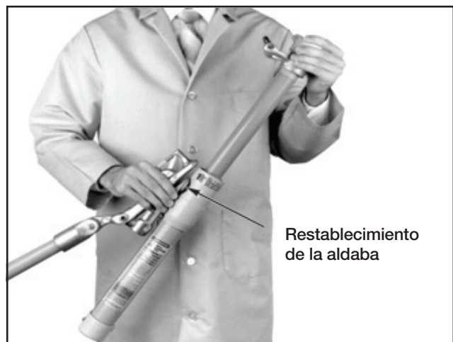
Figura 8. Restablecimiento de la Loadbuster.
