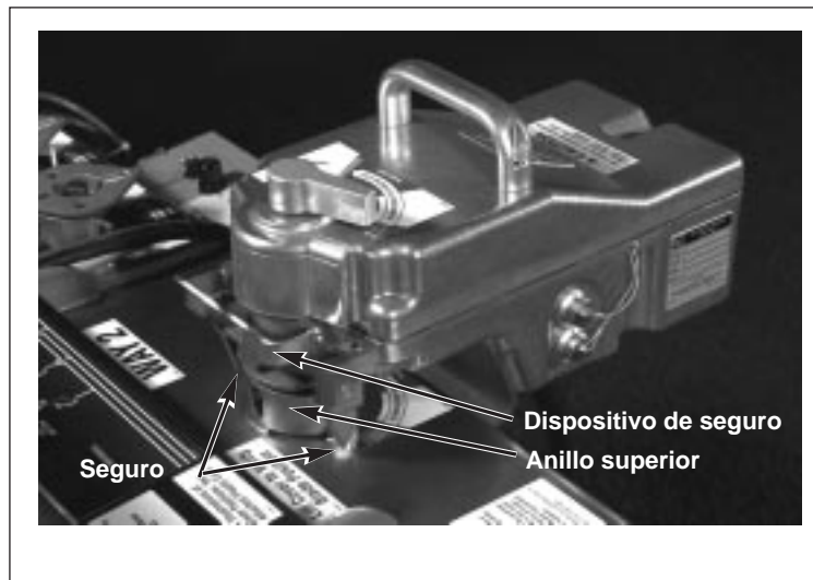
Figura 5. Verificando que el moto-operador portátil está totalmente asentado y asegurado.
